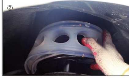
3. Buffer oluklarına da sabunlu su ya da silikon sprej sıkılmalıdır. Yukarı şemada verilen montaj bölgelerine dikkat edilerek buffer yerine oturtulur.
