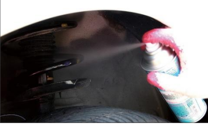
2. Helezon yay temizlenir, sabunlu su ya da silikon sprej sıkılır.
