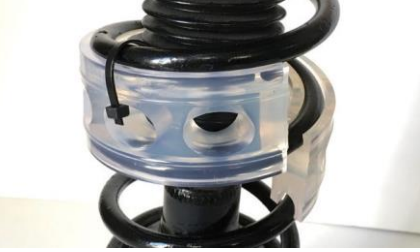
5. Üst kısımda baştan ikinci deliğe plastik kelepçe takılır.
