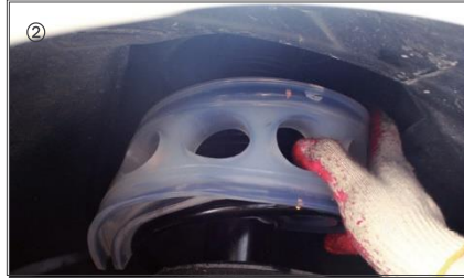
3. Buffer oluklarına da sabunlu su ya da silikon sprey sıkılmalıdır. Yukarı şemada verilen montaj bölgelerine dikkat edilerek buffer yerine oturtulur.
