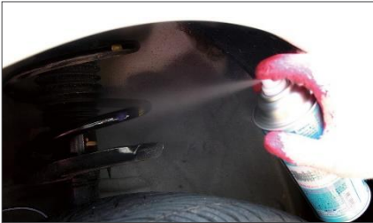
2. Helezon yay temizlenir, sabunlu su ya da silikon sprey sıkılır.
