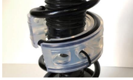
6. Alt kısımda sondan ikinci deliğe plastik kelepçe takılır.
